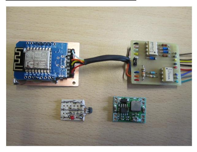
... der Eigenbau-Sensor und die Befestigungsplatine für den Wemos werden auf der Lötseite bestückt und wie zu sehen ist, hab ich dem Wemos auch noch eine Steckverbindung spendiert. Somit kann er ohne löten ausgetauscht werden.
